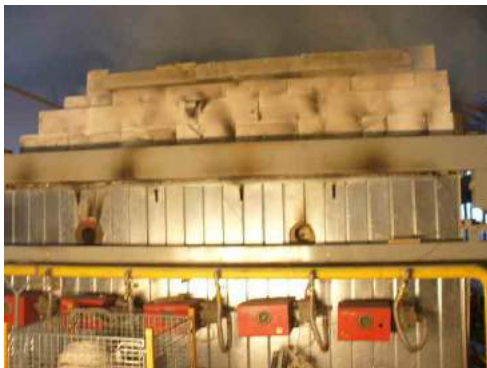
Zdjęcie komory ogniowej przeznaczonej do testów wg DIN 4102-12
